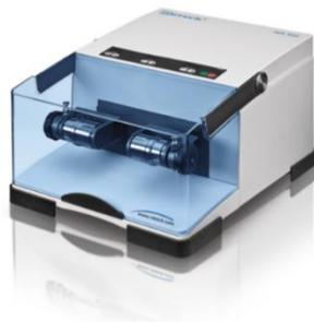
**Figura 01.** Moinho de bolas tipo mixer - empresa Retsch - MM 40<sup>27</sup>
