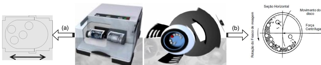
**Figura 05.** Movimento esquemático no moinho tipo mixer (a) e no tipo planetário (b)<sup>27</sup>
