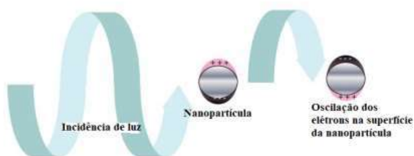
Figura 14 - Origem de um dipolo elétrico induzido e efeito da força restauradora devido à separação de cargas nas nanopartículas metálicas. Adaptado da referência (EUSTIS, 2006).
