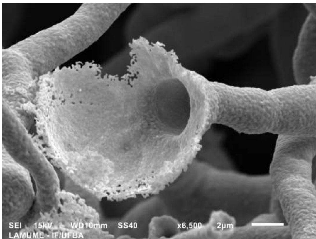
Figura 47 – Imagem obtida por microscopia eletrônica de varredura dos microtubos de ouro após a remoção do fungo filamentoso da espécie Phialomyces macrosporus via tratamento térmico com aumento de 6500X.
