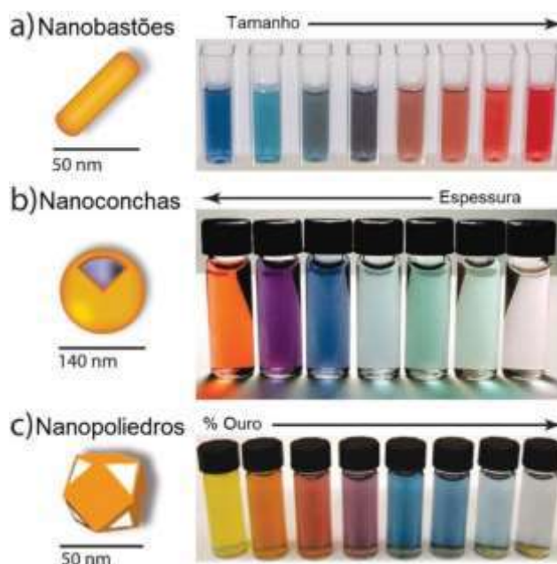
Figura 13 – Nanopartículas de ouro em diferentes formas geométricas. (a) Nanobastões, (b) Nanoconchas, (c) Nanopoliedros. Adaptado da referência (de EL-SAYED, 2012).
