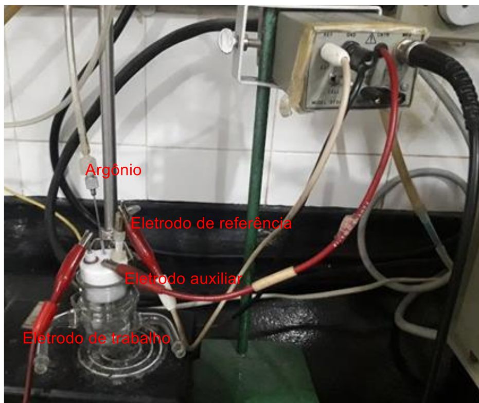
Figura 18 - Esquema de célula eletroquímica contendo 3 eletrodos: eletrodo de referência, eletrodo de trabalho e eletrodo auxiliar.
