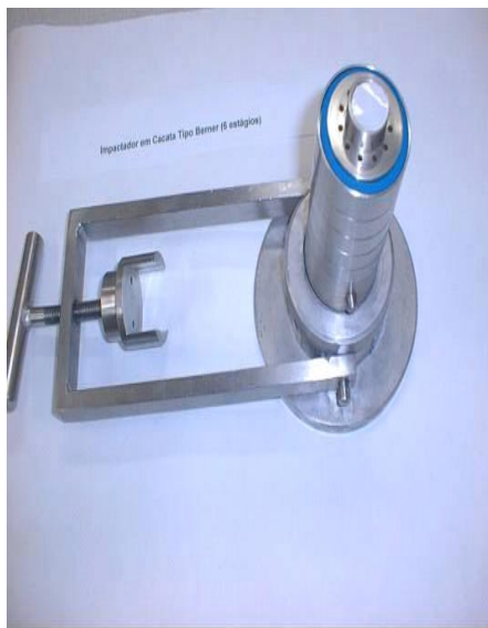
Figura 9 Impactador em cascata montado - vista dos estágios do impactador em cascata e filtros
