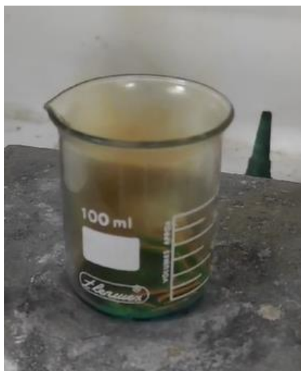
Figura B2. Dissolução ácida do cobre eletrolítico
