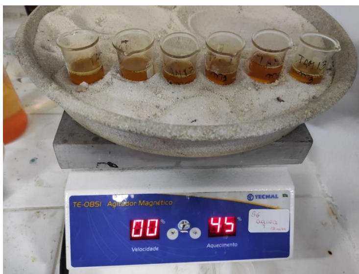
Figura B1. Digestão ácida dos catalisadores C_{10}A^{CP} e C_{10}Ce_5A^{SQ}
