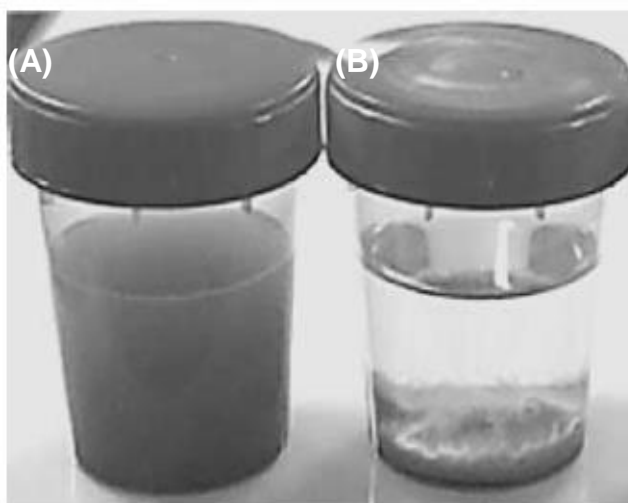
Figura 31. Imagem digital mostrando o efeito do micélio fúngico em uma suspensão de amianto. (A) Solução aquosa com amianto e (B) sem amianto dispersos em solução, após assimilação do mesmo pelo fungo.
