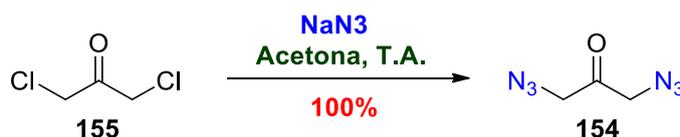
Foi adicionada azida de sódio (20,55 mmol) a uma solução contendo 1,3-dicloroacetona **155** (4,05 mmol) em acetona (15 mL). A mistura foi agitada à temperatura ambiente overnight. O sólido foi removido por filtração e o filtrado foi concentrado em vácuo para obter um óleo amarelo (0,5672 g) **154**. Foi usado de imediatamente após preparação.
