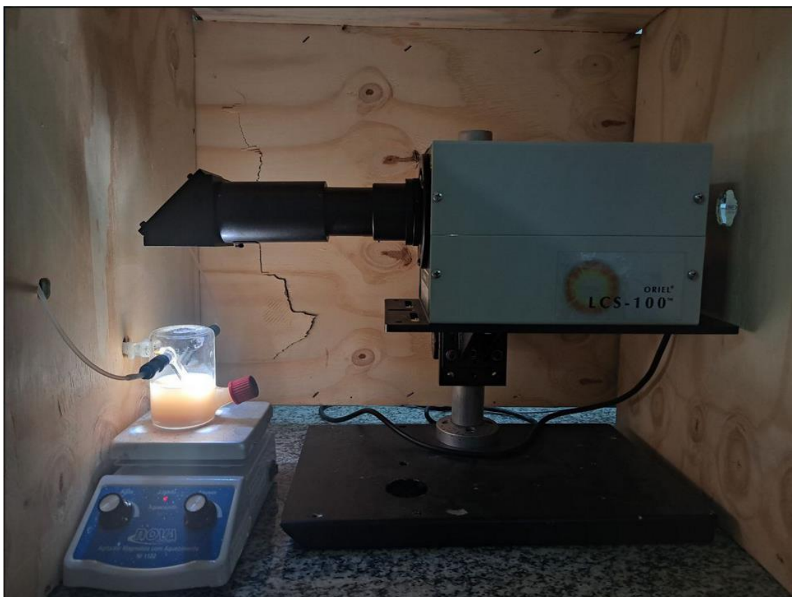
Figura 10: Sistema fotocatalítico empregado: fotorreator e simulador solar
