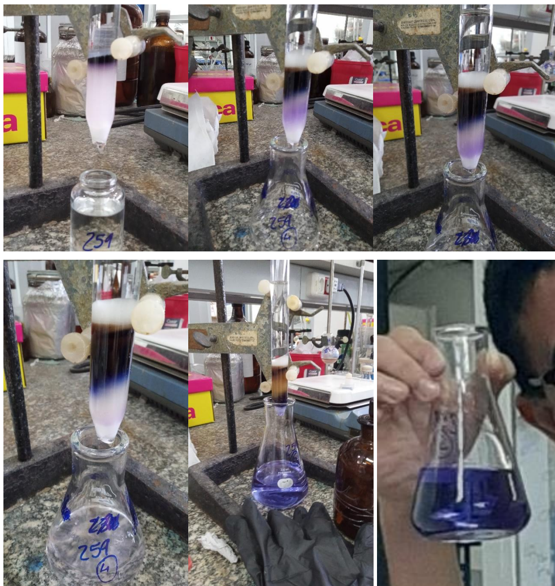
Figura 26. Etapa de isolamento da enaminona da indanodiona por coluna cromatográfica clássica.
