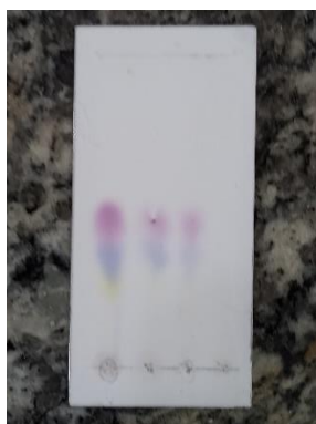
Figura 25. CCD da mistura reacional na síntese da enaminona da indanodiona.
