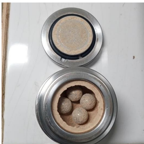
Figura 3: Aparência do meio reacional pulverizado na reação da AIP e da acetilacetona via ativação mecanoquímica com a adição de sílica.
