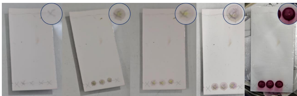
Figura 23. Aspecto da indanodiona em placa de sílica para CCD. A imagem mais à direita corresponde à placa de CCD após ser mergulhada em banho de etanol para limpeza.
