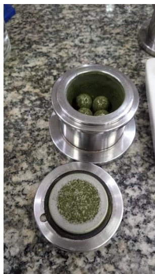
Figura 24: Aspecto do meio reacional após 30 minutos de moagem dos reagentes (mecanoquímica).
