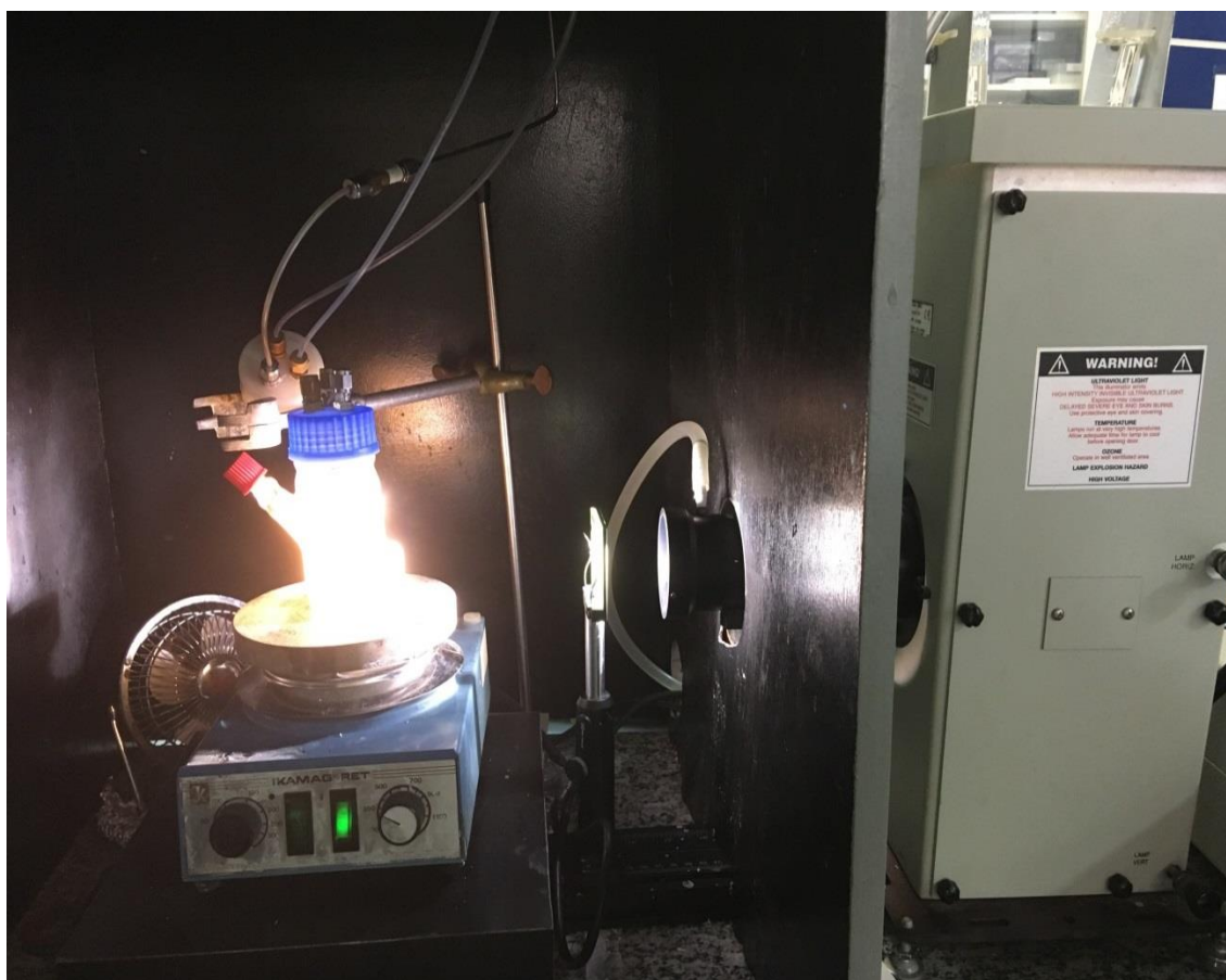
Figura 14. Mistura confinada no fotorreator sob irradiação ultravioleta.
