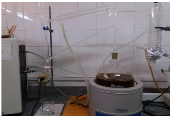
Figura 17. Sistema Clevenger modificado para extração de óleo essencial. Fonte: Própria.
