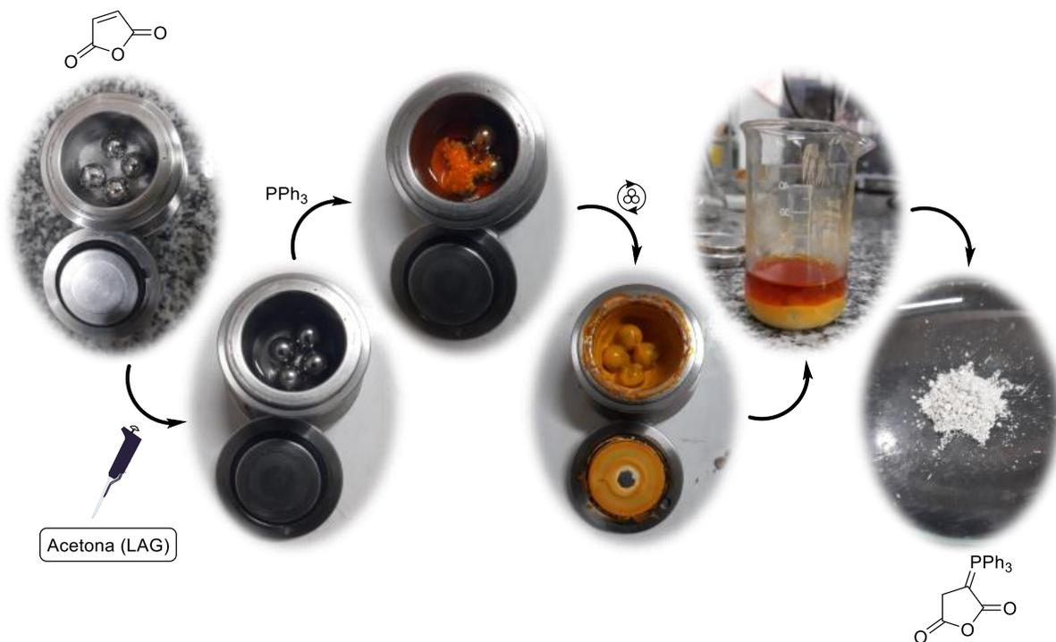
**Figura B1.** Registros fotográficos da síntese do anidrido  $\alpha$ -trifenilfosforanilideno-succínico (**3**) via mecanoquímica (2 mmol) e a respectiva sequência dos eventos realizados.
