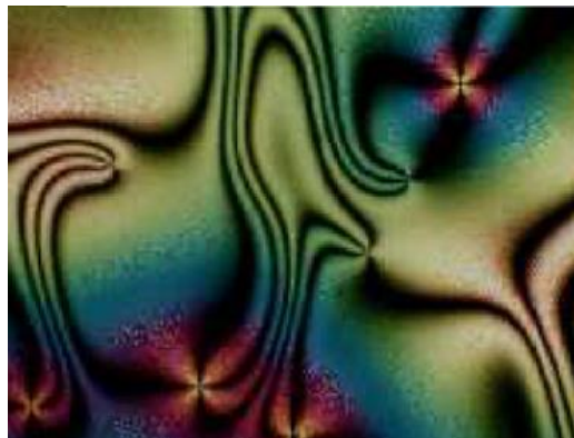
Figura 22: Textura Schlieren de um filme nemático com defeitos pontuais na superfície.
