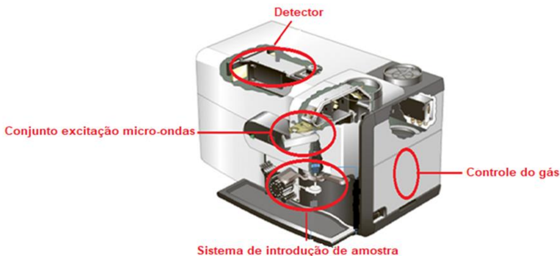
Figura 6 - Componentes de um espectrômetro com plasma de micro-ondas gerado por \text{N}_2 (MP-AES 4200, Agilent Technologies).
