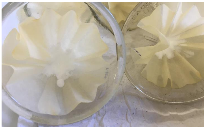
Figura 4.4 – Precipitado branco formado após irradiação das soluções de \text{BaCl}_2 0,5 \text{ mol L}^{-1} , por MW na presença do TAD contendo solução de (\text{NH}_4)_2\text{S}_2\text{O}_8 2 \text{ mol L}^{-1} .
